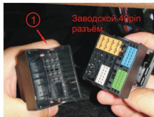
2. Отсоедините заводской 40pin разъём, подключите его к 40pin разъёму видеоинтерфейса ①
