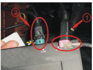
5. Позиция 1 на картинке должна быть подключена к позиции 2 (LVDS видеовход видеоинтерфейса).
