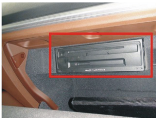
1. Откройте перчаточный ящик и извлеките основной блок.
